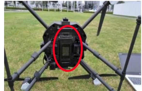
ドローンで事前に上空電波状態を測定し、電波エリアを3次元で管理（圏外領域がないことを確認）
