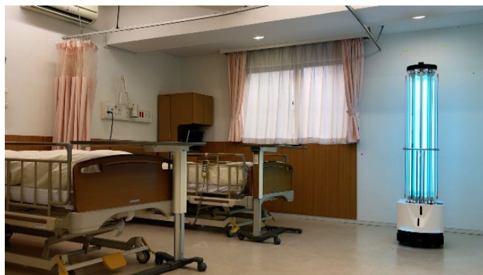
図 7 ロボットによる除菌作業のイメージ
