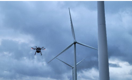
← 風車ブレードを撮影するドローンの様子
